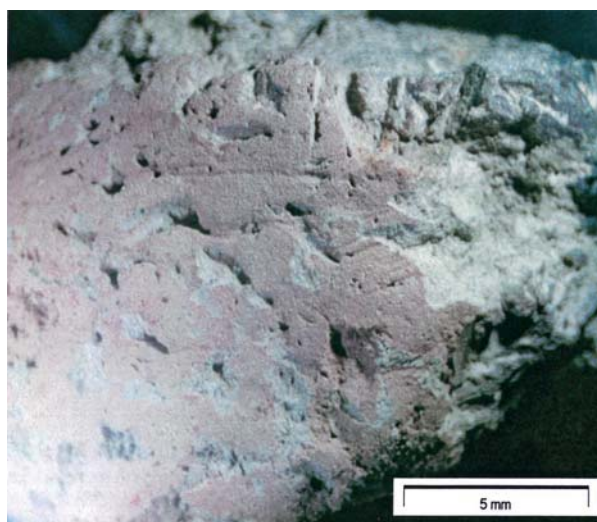
Figur 2. Foto av möjligt ässjefodringsfragment F434 från A400, Jonsberg. Hålrumsen i den lägre brända delen av fragmentet härrör sannolikt från organisk magring.
