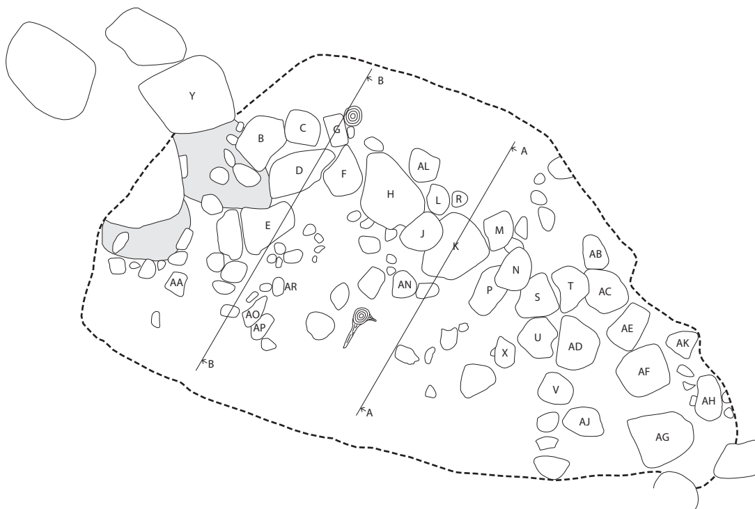
Figur 31. Plan över schaktet över RAÄ 220. Den sträcka som utgår från den jordfasta stenen Y och fram till stenen märkt K är den igensatta grindöppningen. Här fanns också all skärvstenen placerad. Resten av sträckan har haft en staplad murkonstruktion. I de fall där stenarnas ursprungliga placering syns i marken har detta markerats med streck. Oftast syns märken efter stenarnas ursprungliga uppställningsplatser i marken. Dessa har ofta formen av grunda gropar och i många fall finns också småsten som kilat fast dem på plats kvar. Dessa kallas "ställgropar" i Franzéns terminologi. Tydliga sådana fanns bara på fyra ställen, vid sten D, H, K och AG. Att inte fler kunde identifieras beror på att mursträckningen mellan sten K och AF varit staplad, något som klart framgår av fallriktningen på de stenar som ligger nedanför murlivet. Den sista stenen AG har varit rest, men om detta betyder att den vidare mursträckningen också varit ställd går inte att avgöra eftersom ett långt avbrott till följd av skada finns direkt utanför schaktet här. I den andra ändan av schaktet vidtar en mur byggd av större kraftigare sten som ingått i en upprest ställd mur.
