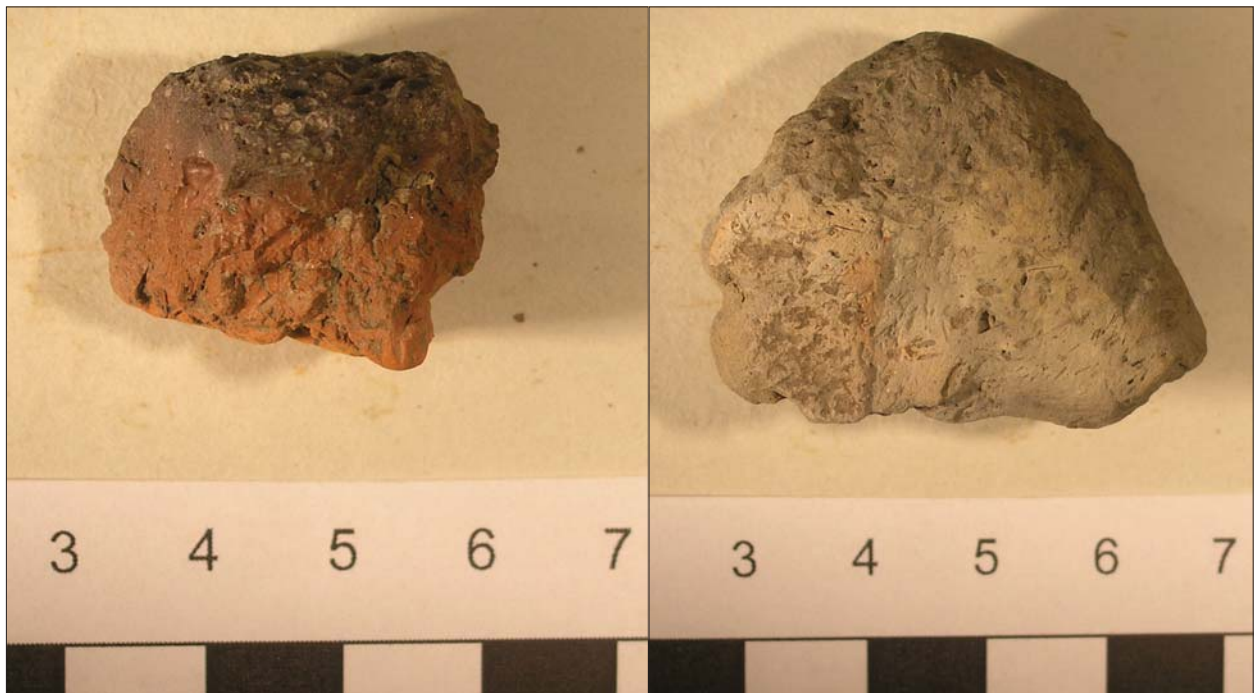
Figur 4a. Bild av fragmentet av ässjafodring, som har analyserats som TS 2.
