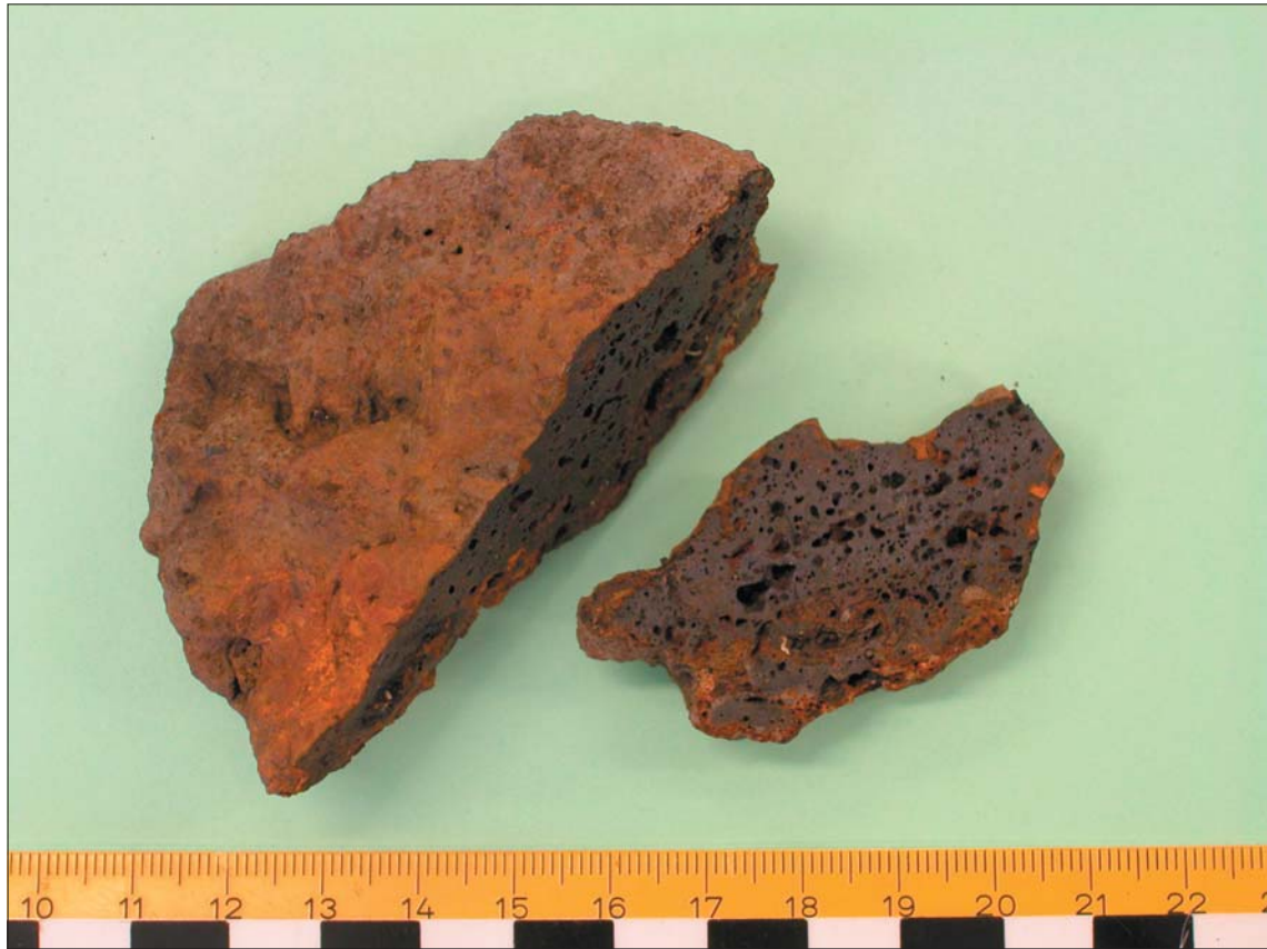
Figur 1a. Slagg F90 (A9330), delad. Det analyserade provet till höger.
