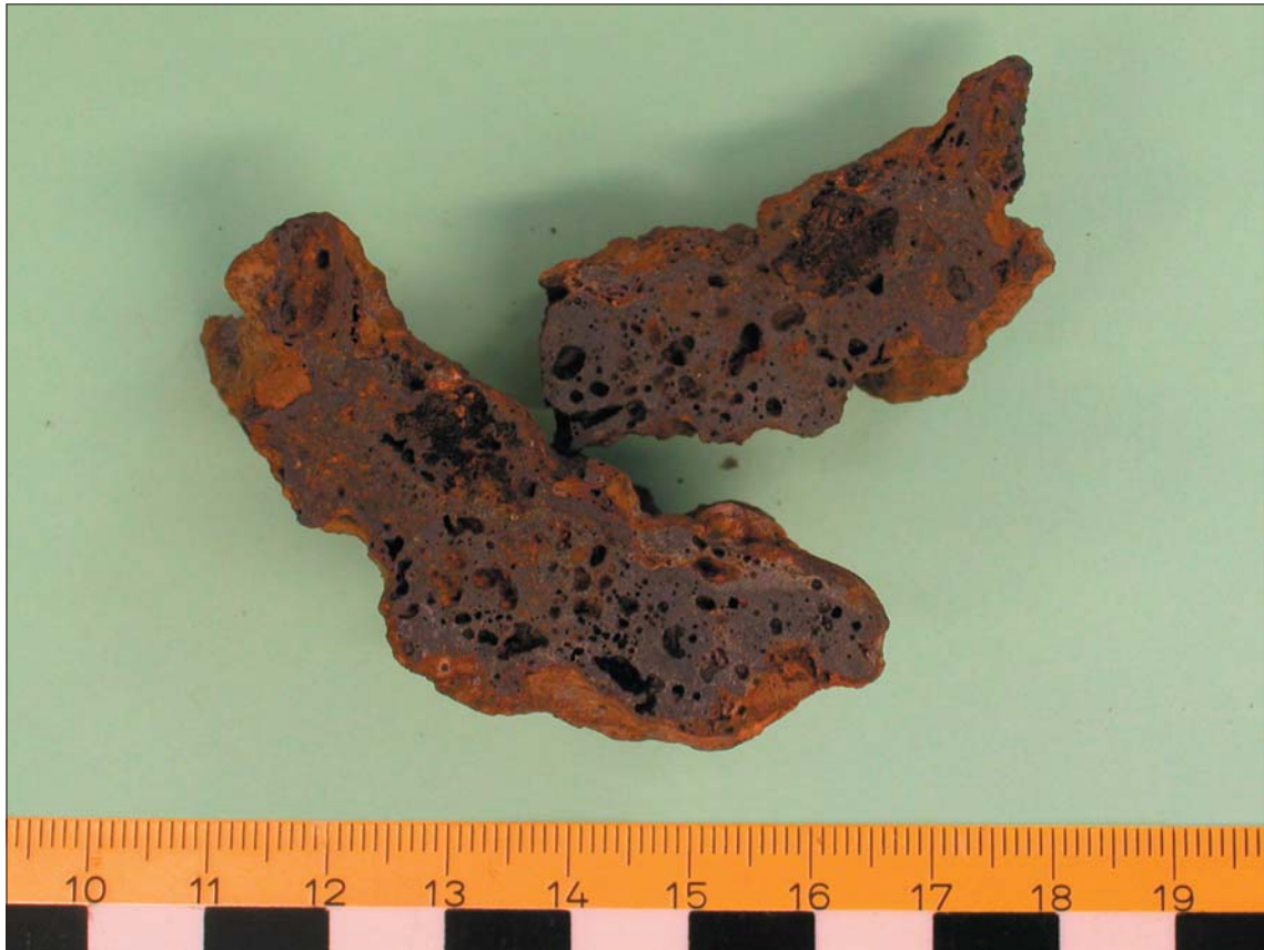
Figur 2b. F106 (A9331), delad. Slaggen är homogen i sin uppbyggnad. Ett tunt rostsikt täcker hela slaggens ytterkanter. I övre högra delen framträder tydligt ett inneslutet kolstycke.
