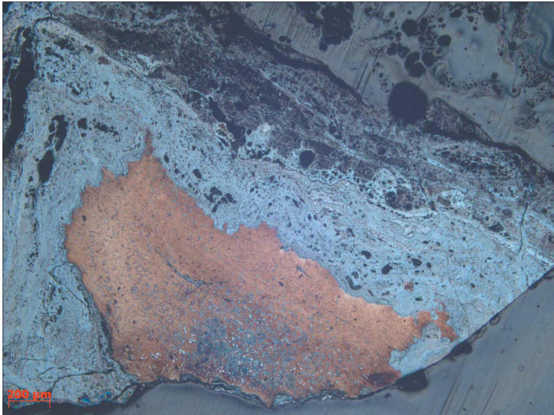
Figur 8c. F107 (A9331), mikrofoto. Metalliskt järn. Provet är etsat med nital. Metallen är brun. Om-givande rostskikt och slagg har olika grå nyanser. Kolstycken är något mörkare.
