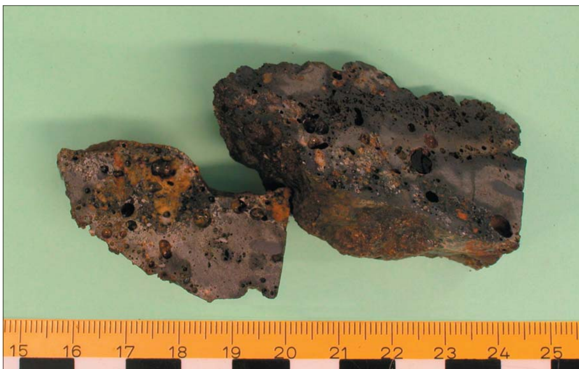
Figur 4c. F100 (lösfynd), delad. De mörka delarna är slagg, de ljusare är mineralkorn.
